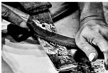
② キキルを用いて削ることで音高を調整する。鍵盤を保持するための二つの穴の中間を削ると音が低くなり、外側を削ると高くなる。二つ穴の位置は、振動の節と重なるようになるよう設定されている。節と節の間を削ることによって、ごくわずかだが重さが減り、節の間が延びるので、音が低くなる。いずれにしてもごくわずかな変化である。
