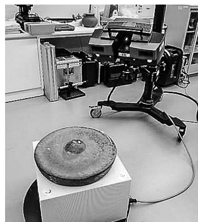
図7 3D デジタイザによる計測の様子
