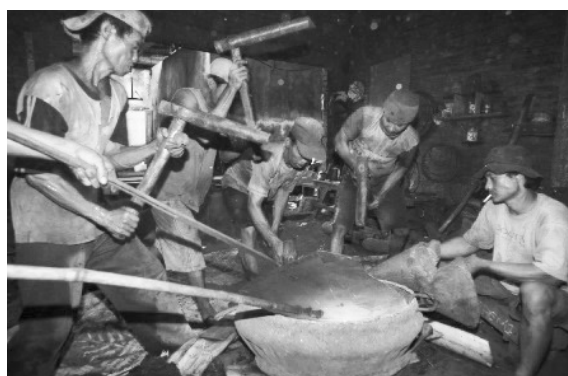
写真4：モジョラバンにおける青銅製『ゴング』の熱間鍛造
