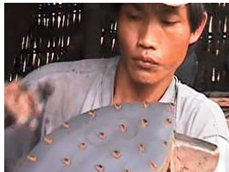
②-a 粘土の変形具合を見て、内型と外型の間隙の確認をする。
