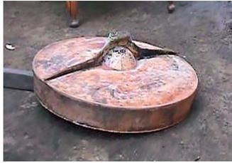
型から取り出されたゴング。外型の接合部分の隙間を伝って流し込まれた金属が板状になって残っている。これをディエウという。
