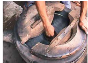
②-c 調整した二つのトーを外型に入れこぶの部分に粘土を入れる。
