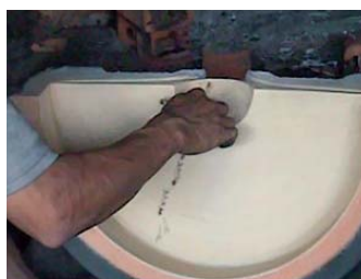
③-b 外型のダット・ロットでできた部分は、黄色く焼きあがる。ひびが入った部分に粘土を塗ったり、削ったりして表面を整える
