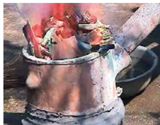
①-a 窯（ロ・ナウ・ドン）で材料を溶解する。
