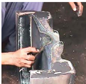
① 半円の外型を接着するために、接合面にダット・ロットを塗る。
