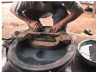
②-a トーを外型の中にはめ、外型の淵に沿わせてすり合わせる。
