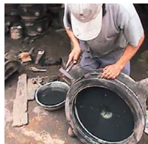
① 二つの型を合わせ、周囲を鉄の輪っかで締める。
