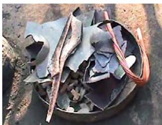
①-a 鑄造製品のかけらや、破片、銅、鉛など。右端に、新しい銅と錫が加えられている。
