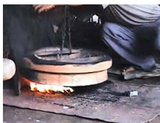
③-b 内型を紐で宙吊りにし、回転させながら、ゴムを燃やすことで生じる煙で燻す。
