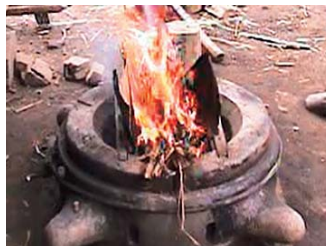
②-b 型の上で火を焚いてトーとコットの間の粘土を焼き固め、両者を結合する。
